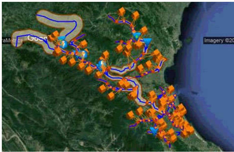
Hình 7: Sơ đồ thiết lập tính toán trong MIKE BASIN cho hiện trạng lưu vực sông Cả
