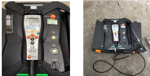
Hình 7. Thiết bị đo khí độc hại trong khí xả
