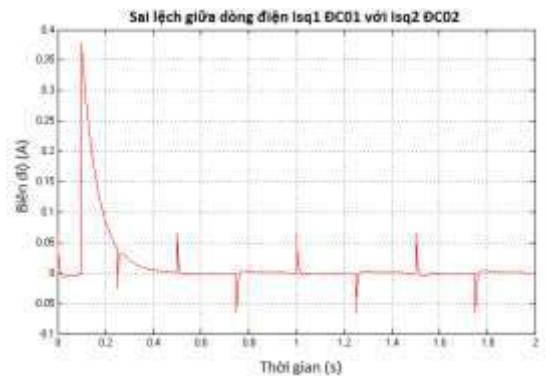
Hình 12. Sai lệch giữa I_{sq1}; I_{sq2} khi áp dụng bộ điều khiển PI thích nghi
