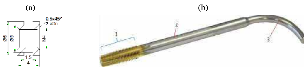
Hình 1. Đai ốc M4 (a) và kết cấu một ta-rô chuôi cong (b)
