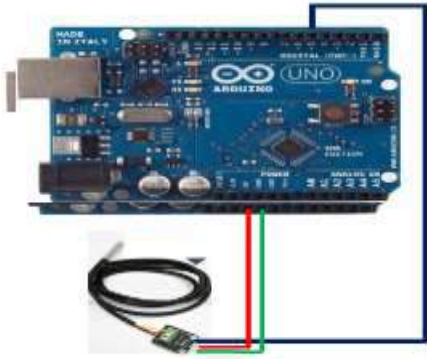
Hình 1. Sơ đồ nguyên lý mạch cảm biến nhiệt độ dùng DS18B20
