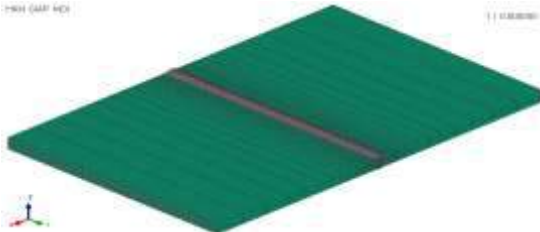
Hình 5. Mô hình hoá liên kết hàn
