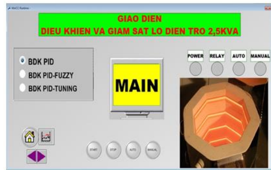
Hình 11. Giao diện chính điều khiển và giám sát lò điện từ 2,5KVA trên PCL
